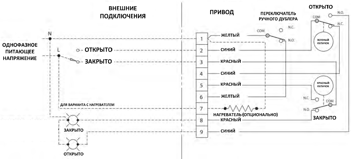
Схема подключения базового блока концевых однополюсных выключателей Form-C (SPDT). (Рисунок для привода в полностью закрытом состоянии)
